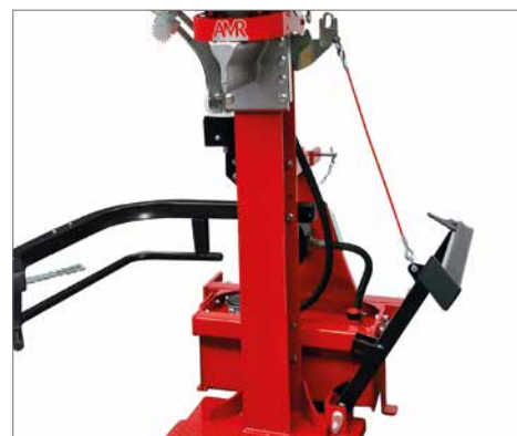
Lève-bûches mécanique breveté de série
