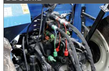
Branchement hydraulique directement sur le tracteur
