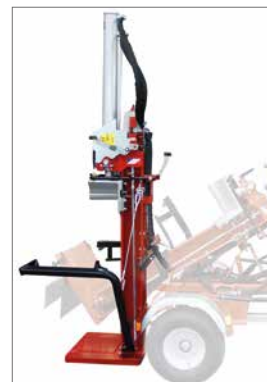
Mise en position de travail hydraulique
