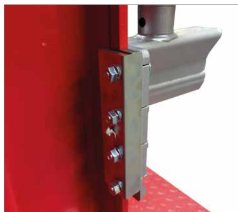
Glissières en laiton avec graisseurs
