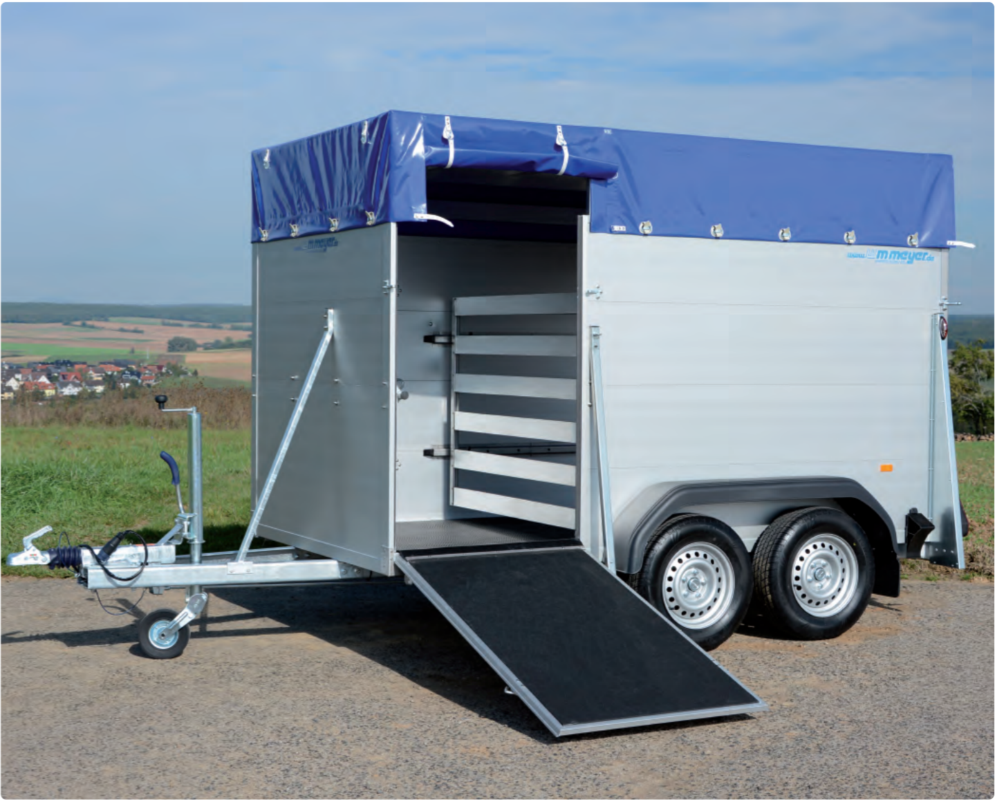
V 2730/164 Vollaluminiumanhänger, Zubehör : Gummiboden, Frontausstieg, Trenngitter, Hochplane und Aluspiegel V 2730/164 Bétaillère complètement en alu, options : protection plancher, pont avant, séparation à l'intérieur, bâche haute et ossature en alu V 2730/164 All-aluminium trailer, optional extras: rubber floor covering, front exit, cross division, high canvas top and aluminium support
