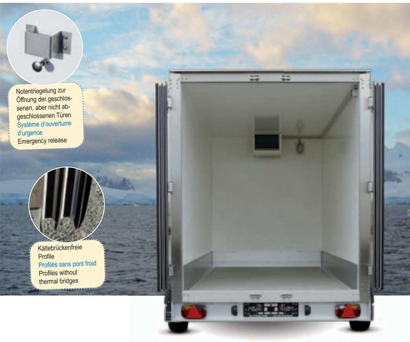
AZK 2734/180 100/100 TK Boden, Wände, Tür, Dach: 100 mm, Kunststoffboden besandet, Aluscheuerleiste, Sonderausführung ohne Klappkurbelstützen, WMK 4 AZK 2734/180 100/100 TK Plancher, panneaux, porte, toit : 100 mm, plancher sablé, plinthes alu, version spéciale sans béquilles à relever, groupe froid WMK 4 AZK 2734/180 100/100 TK Platform, side panels, door, roof: 100 mm, sanded platform, alum. skirting board, special version without prop stands, cooler unit WMK 4
